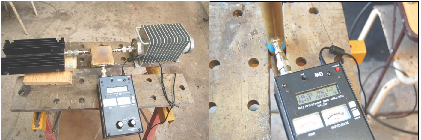
A gauche, calibrations du diplexer et à droite de la TopfKreis 144 MHz
